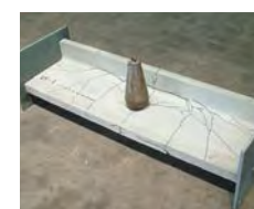
▲踏板的衝撃試験状況
